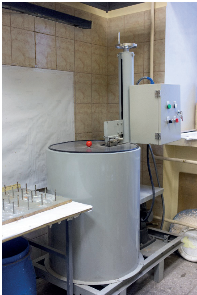
Рисунок Д – Смесители для приготовления огнеупорной суспензии MZJ60 с охлаждаемой лопастью
