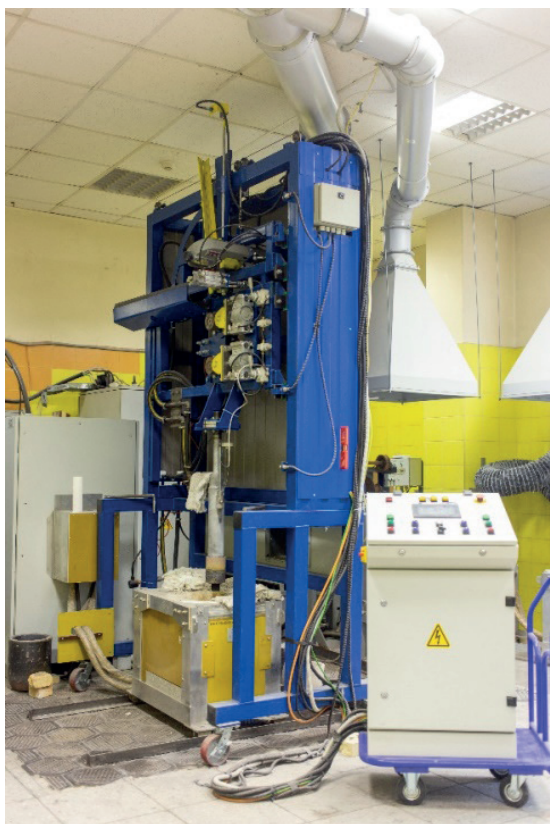
Рисунок А – Портальная установка вертикального литья вверх ПУВЛ-450 с индукционной тигельной печью
