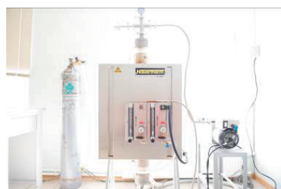
Рисунок 10 – DSC Labsys с дополнительным 3D детектором типа (Tian-Calvet) для измерения C_p
