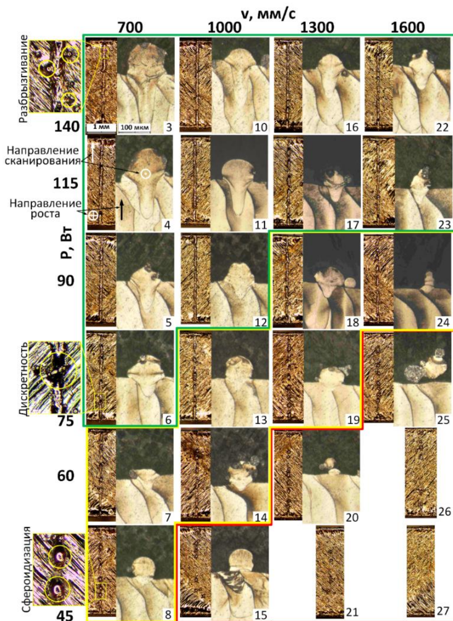
Рисунок 6 – Изображения следа от единичного прохода лазера и ванн расплава, сформированных единичным проходом лазера в зависимости от режима СЛП [6]
