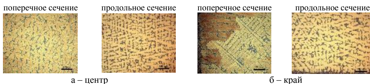
Рисунок 5 – Характерная микроstructure поперечного и продольного сечения бронзового прутка №1 (с 14 мас. % Sn), полученного полунепрерывным литьем
