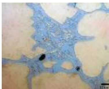
б – включения эвтектоида
