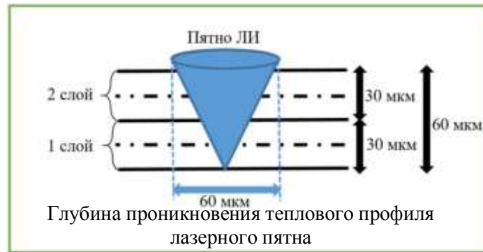
Рисунок 42 – Схема установленной оптимальной высоты единичного порошкового слоя для SiC с целью обеспечения адгезии с предыдущим спеченным слоем
