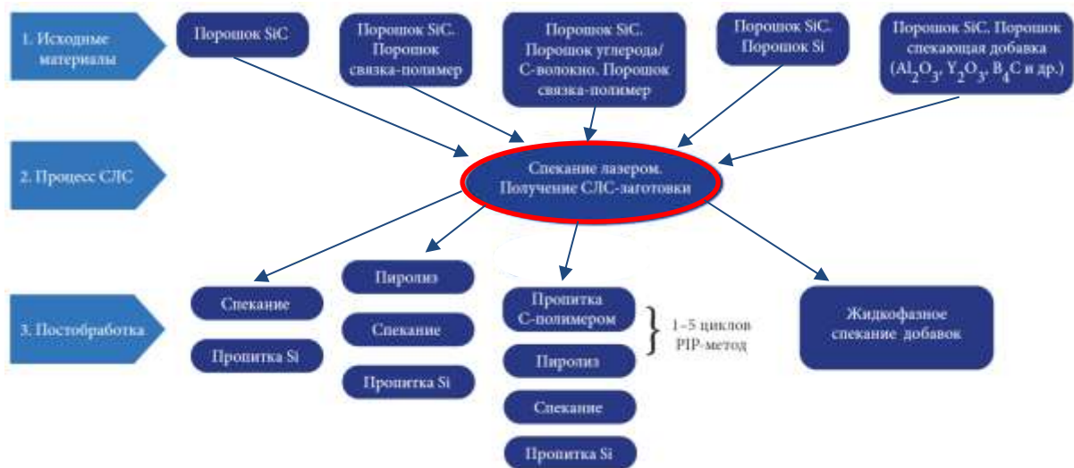
Рисунок 8 - Схема методов формирования изделий из SiC по принципу SLS и их постобработки [2]
