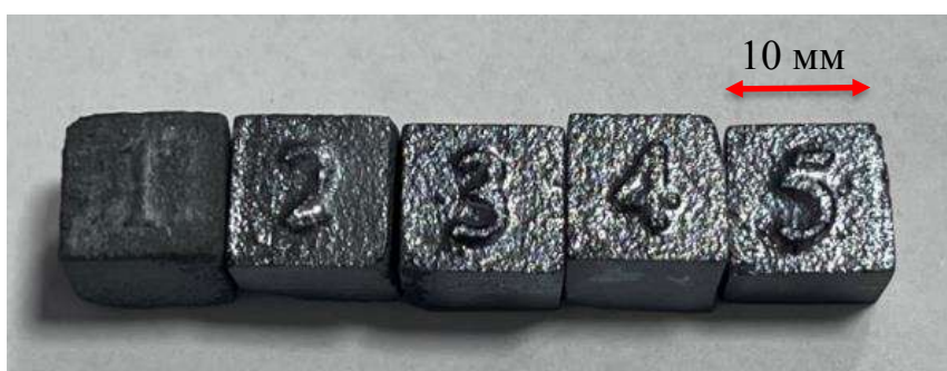
Рисунок 57 – Кубические СЛС-заготовки, прошедшие стадии пироуглеродного уплотнения и силицирования [160]
