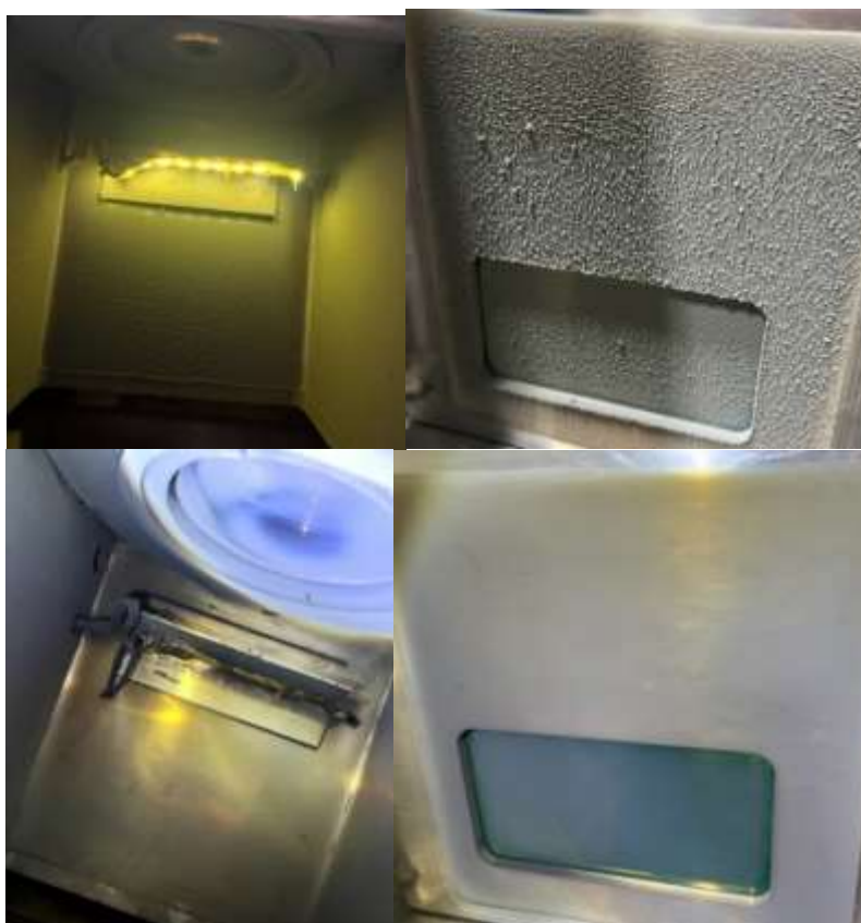
Рисунок 47 – Загрязнение рабочей камеры установки СЛС продуктами распада карбида кремния при лазерном воздействии: а) при избыточном температурном воздействии; б) при близком к оптимальному, обеспечивающему спекание изделия
