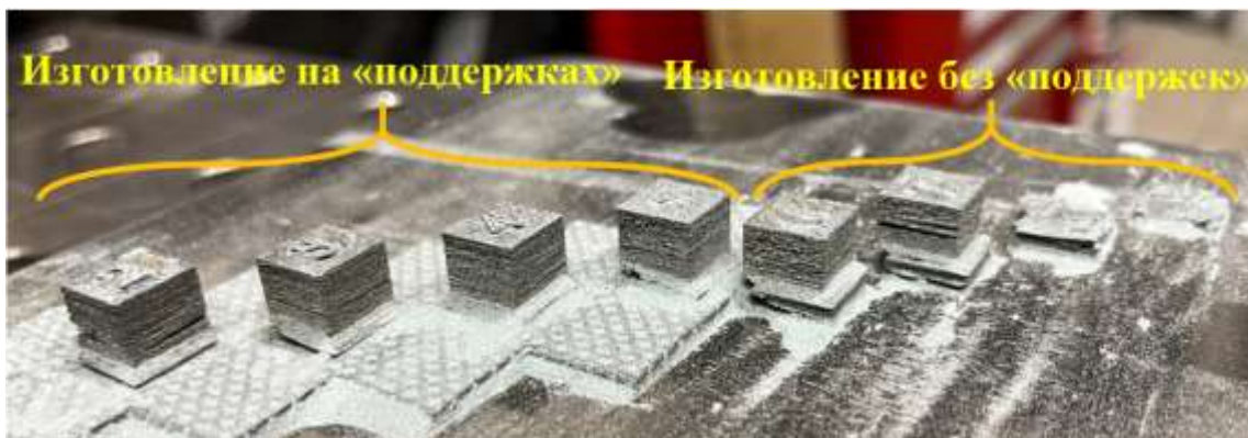
Рисунок 45 – Образцы, выращенные без поддерживающих структур и с их использованием
