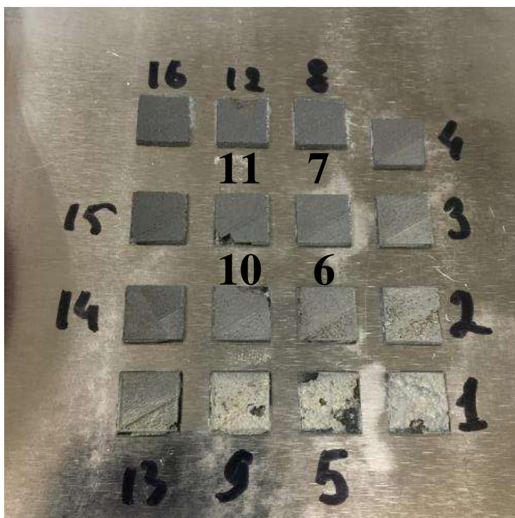
Рисунок 27 – Общий вид изготовленных образцов из порошка SiC методом СЛС
