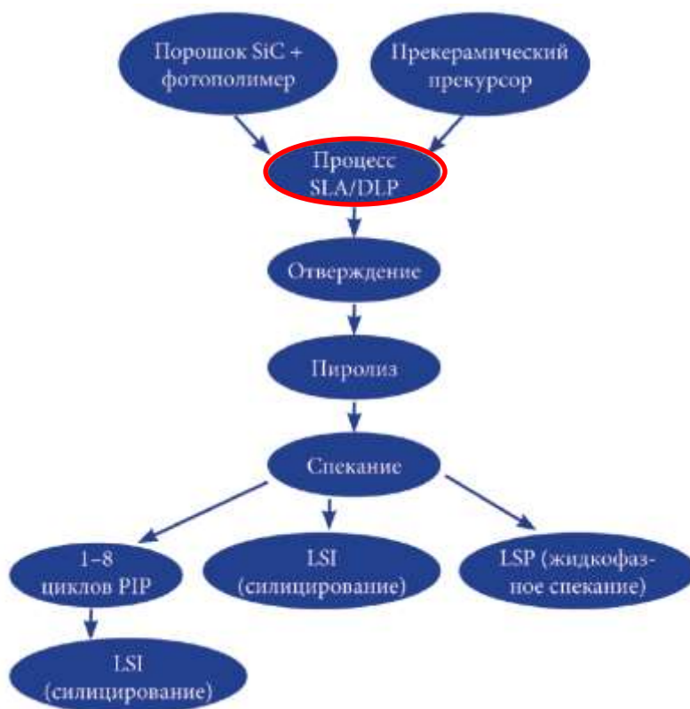
Рисунок 5 – Схема методов формирования изделий из SiC по принципу SLA и их постобработки [1]
