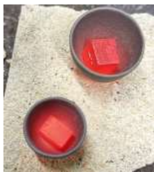
Рисунок 67 – Образцы для определения стойкости к окислению после печи
