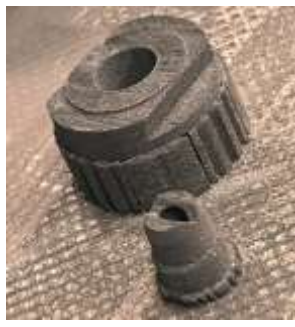
Рисунок 54 – Сборная деталь типа «форсунка», изготовленная с боковыми поддерживающими структурами
