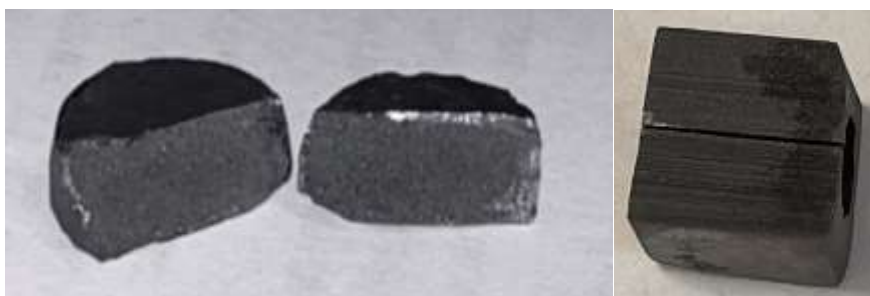
Рисунок 58 – Поперечный излом образца с избыточным количеством циклов пироуглеродного уплотнения после силицирования [160]
