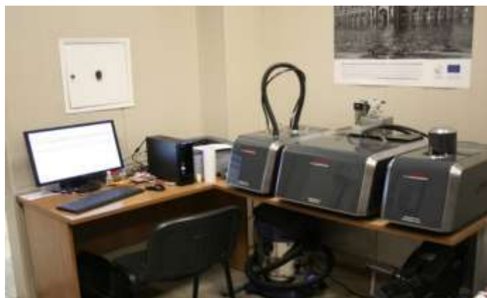
Рисунок 9 – Установка авизирующая размер частиц Dr.FRITSCH «ANALYSETTE 22 MicroTec plus»
