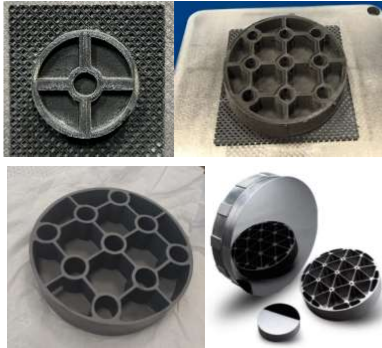
Рисунок 53 – Изготовление макета сложнопрофильного охлаждаемого оптического зеркала из SiC: а) апробация изготовления единичной ячейки, б) изготовление пористой заготовки, в) готовое изделие после постобработки, г) вид аналогичного изделия после полировки (фото из Сети)
