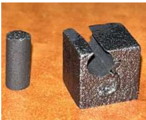
Рисунок 65 – Вырезанный образец для дилатометрии из кубического образца после постобработки в виде LSI
